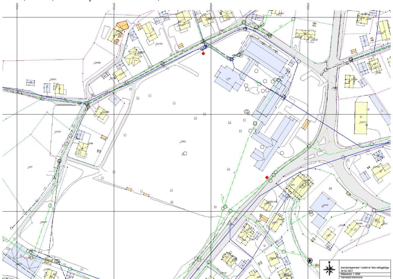
Figur 20, Kartutsnitt, eksisterende VA-ledninger. Kart fra Vennesla Kommune
