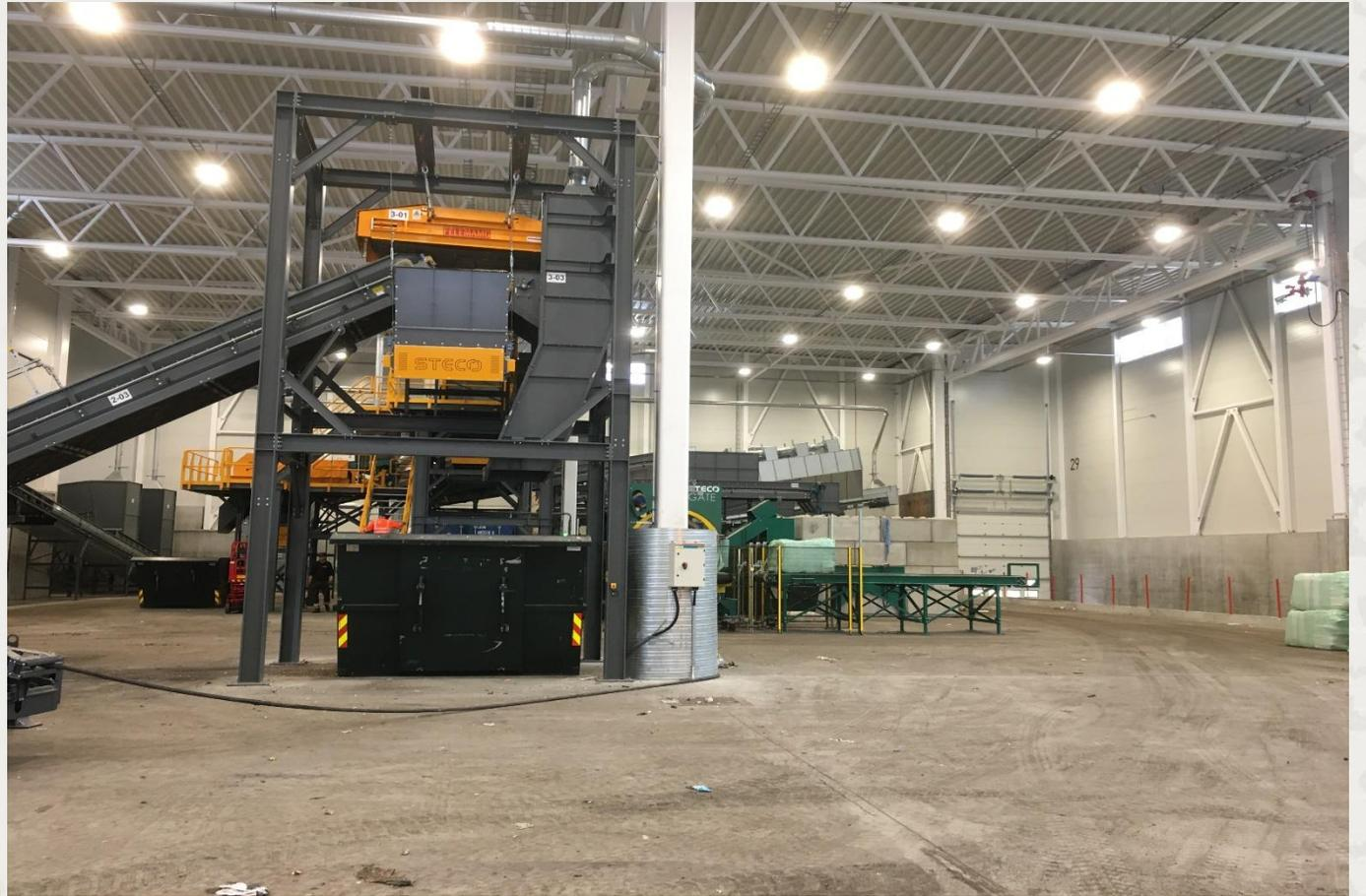
Etter sortering i Eddie Current seperator i 6 fraksjonar, går resten, ca. 70 % til balletering og forbrenning. Eit reint brennbart produkt og høg vektutnytting på transport.
