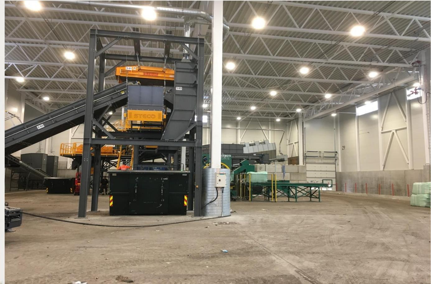
Etter sortering i Eddie Current separator i 6 fraksjonar, går resten, ca. 70 % til balletering og forbrenning. Reint brennbart avfall og høg vektutnytting på transport.
