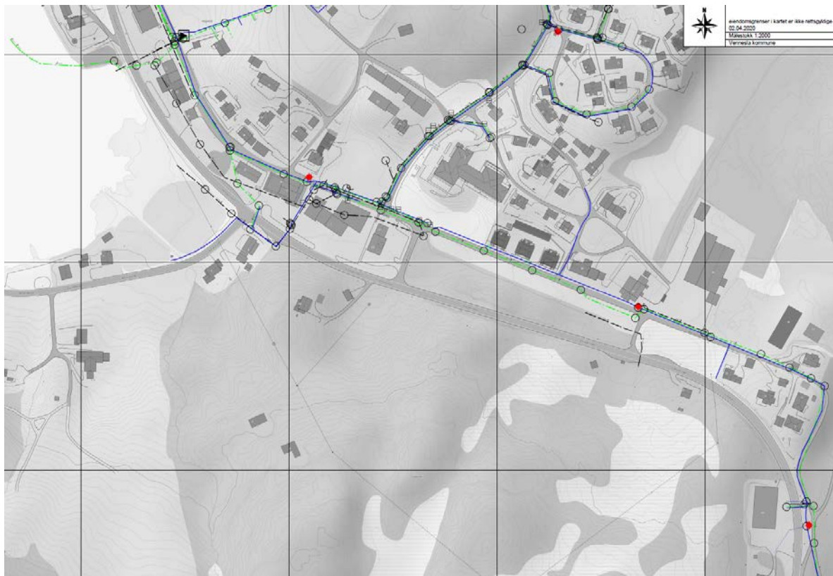
Figur 34, kartutsnitt. Dagens vann- og spillvannsledninger
