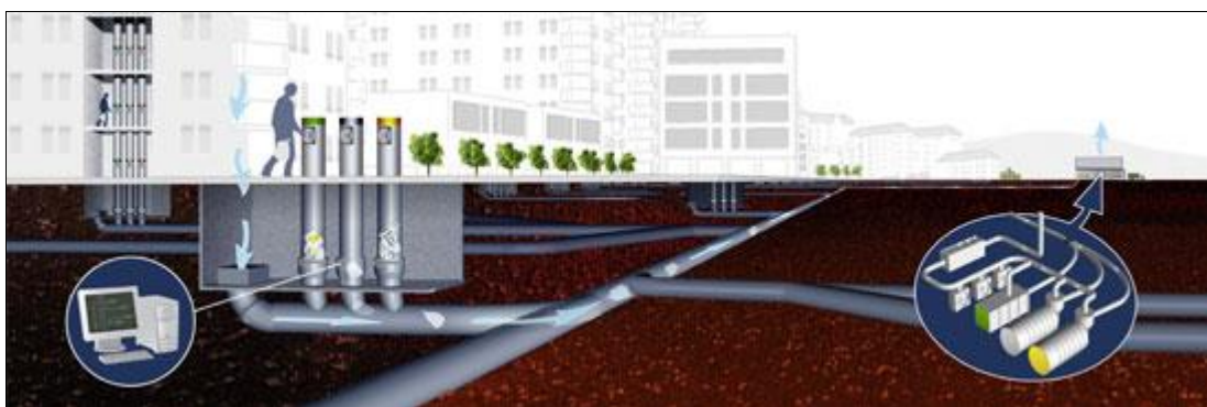
Figur 4.1 Stasjonært avfallssug. (Kilde: www.envac.no )
