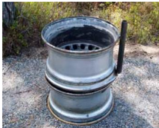
Figur 3. Bålpanne med to traktor- eller lastbilfelger som sveises sammen. Foto: Midt-Agder friluftsråd.
