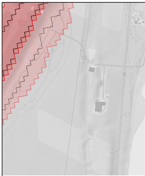
Figur 16 Aktsomhetsområde for snøskred (rødt) og steinsprang (sort). Figuren viser at utløpsområde for snøskred og steinsprang berører planområdet. Kilde NVE Atlas.
