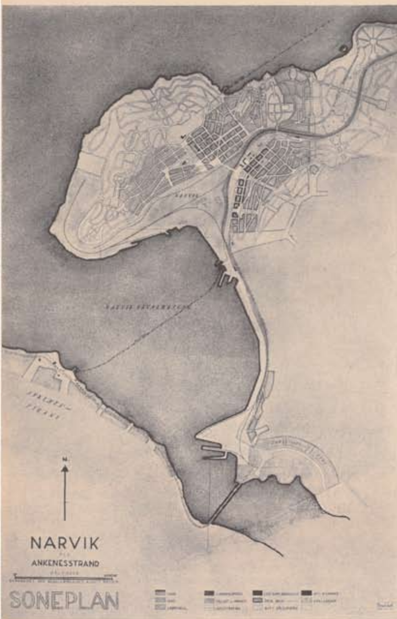
Soneplan for Narvik—Ankenesstrand. Øverst vises Narviks todelte byområde med Frydenlund til venstre og Oscarsborg til høyre. Nederst ses den no ferdige bru fra Fagernes over til Ankenesstrand. Nedover til høyre går Beisfjorden. Ferjeforbindelsen Narvik—Ankenesstrand er inntegnet med strek. Framføringen av den nye riksveg 50 gjennom byområdet vises ovenfor jernbanelinjen. Riksvegen ender no ved ferjestedet Vassvik, hvorfra ferjen går over til Øyjord. For øvrig arbeides det no på riksvegens videre framføring gjennom den hittil ubebygde del av Taraldsvik ned til Ornesvika, rundt Orneshaugen (som strandpromenade) og videre til Djupvik ca. 4 km fra bygrensen, hvorfra det blir ferje over til Øyjord. Strekningen Taraldsvik—Djupvik er under arbeid og beregnes ferdig sommeren 1945. Planen er for øvrig at vegen skal føres videre til Straumsnes, ca. 11 km fra bygrensen, hvor det blir bru over sundet mellom Rombaken og Rombaksbotn. Mål 1:40 000.
