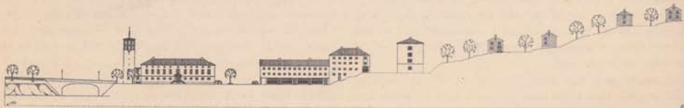
Narvik nye sentrumsplan. Studie til den arkitektoniske bearbeidelse. Snitt gjennom torgaksen på Oscarsborg sett mot nord. Fra venstre ses en del av brua over malmagrene og jernbanesporene. Så følger Rådhusplassen med Rådhuset, Kongens gate og torgbebyggelsen, så Dronningens gate og Rikshuset. Rundt Håreks og Tore Hunds gate er det åpen boligbebyggelse. Mål 1:2.000. (Ark. Oddmund Suul.)
